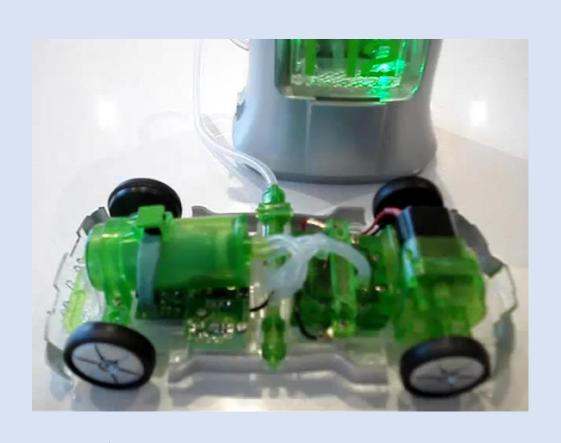
En classe, on branche l'électrolyseur sur la voiture à hydrogène.
